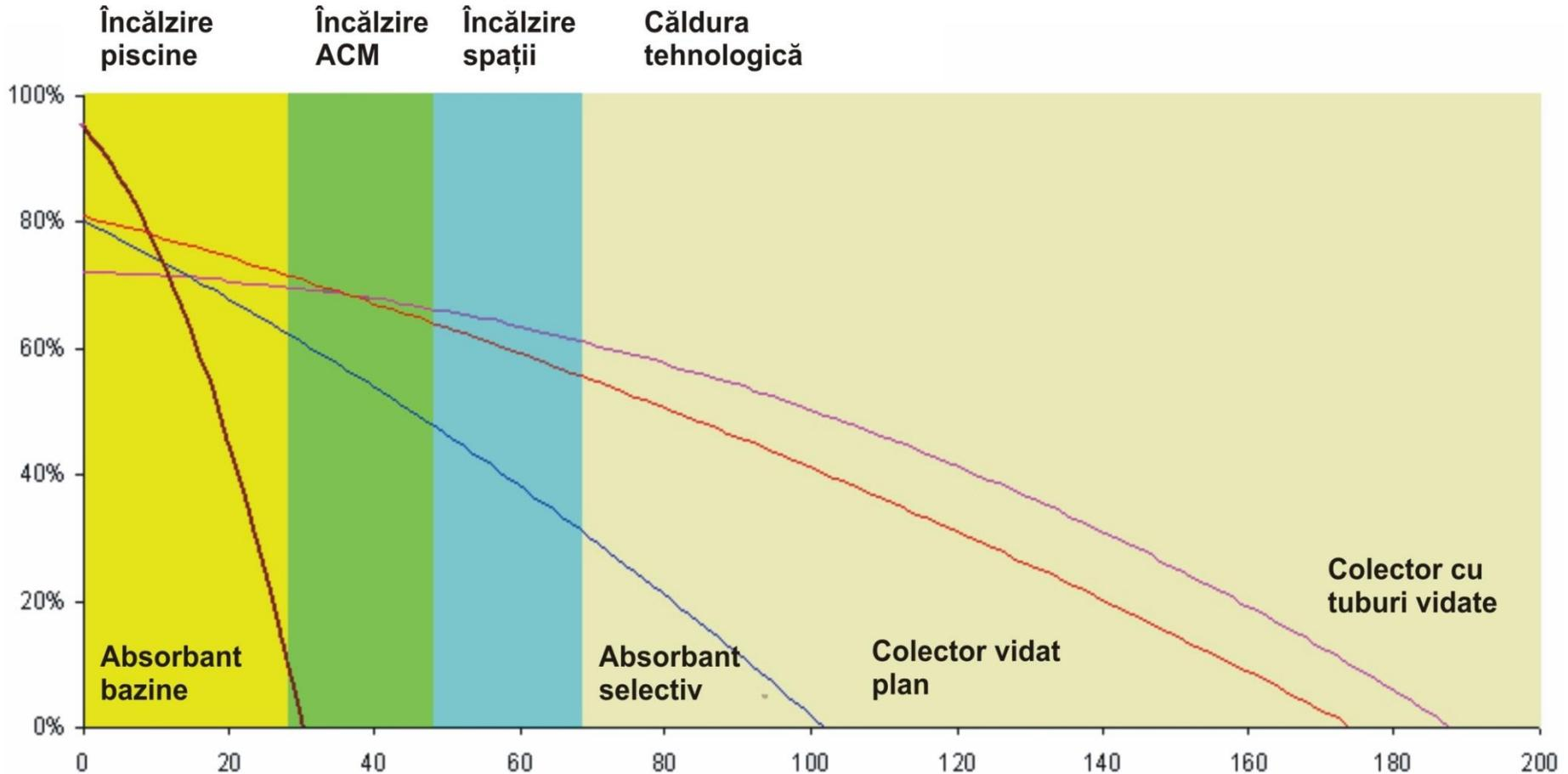
Raportat la perioada unui an intreg diferenta de eficienta intre un panou cu tuburi vidate CPC si unul plan selectiv este de cca 20-24%
