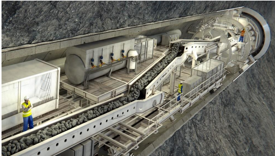
Figura 10-10. Benzi transportoare pentru transportul materialului excavat
