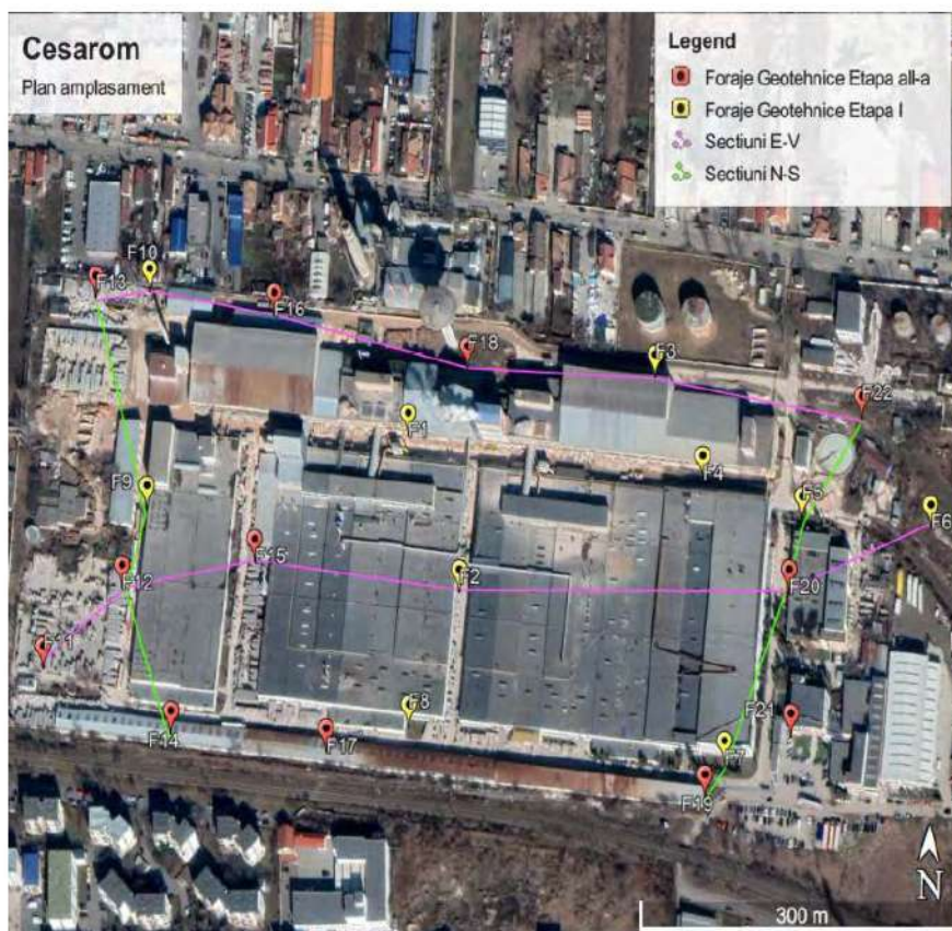
Figura 1 Pozitionarea forajelor pe amplasamentul studiat Sanex
