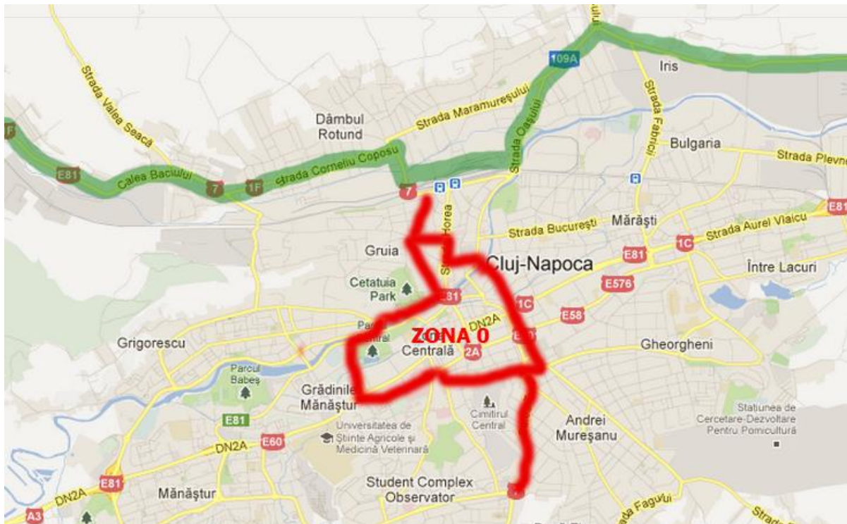
Figura 25 - Transportul rutier de marfă în municipiul Cluj-Napoca: Zona 0 și axa vest-est de tranzit pentru trafic greu (verde)
